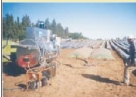
Traitement à la vapeur avec chaudière ambulante (essais sur fraise)
