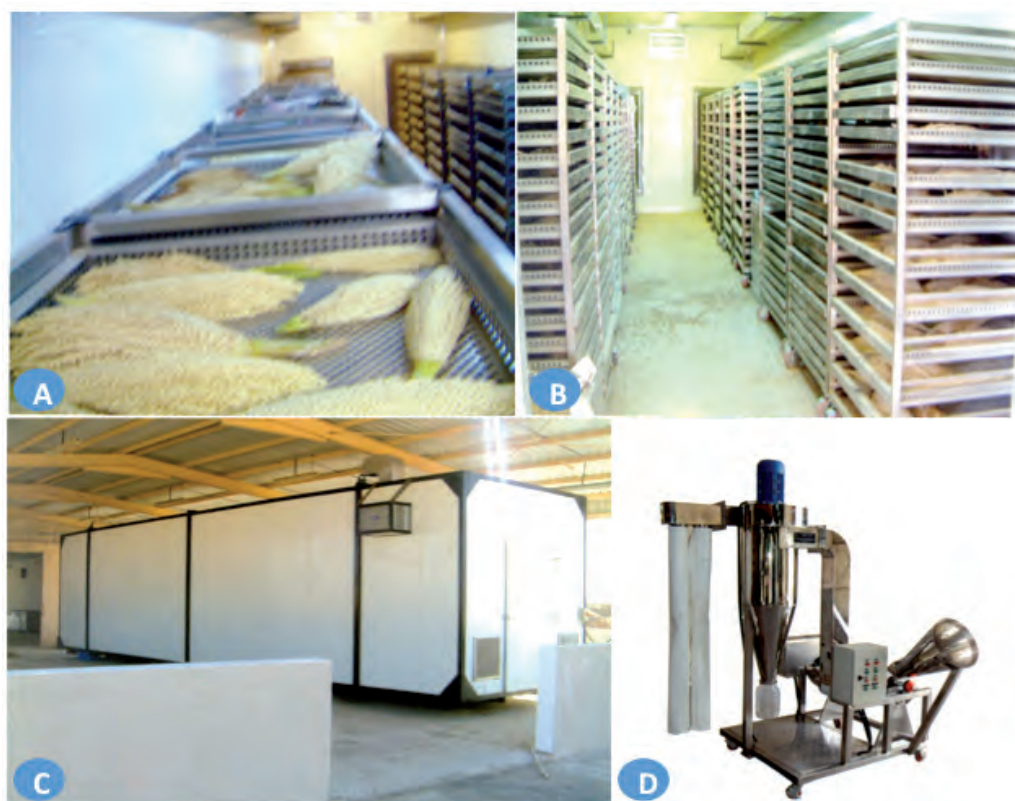
Figure 59. Exemples de local de collecte et d'enceinte électrique de séchage du pollen au niveau des étagères criblées (A, B, C) et appareil d'extraction du pollen (D) (photos : Al-Tamimi, 2011).
