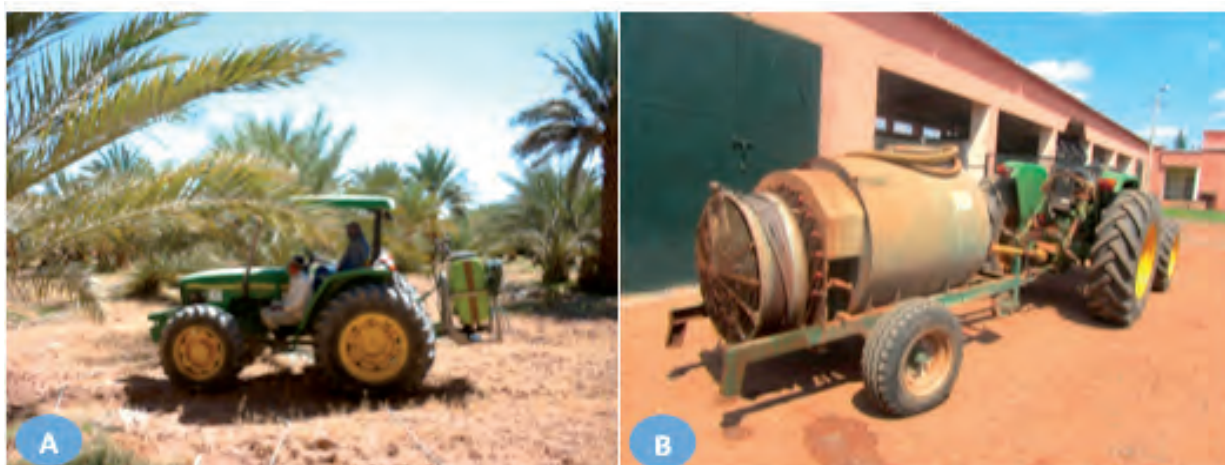
Figure 75. Exemples de matériel de traitement porté (pulvérisateur à lances) (A) sur un tracteur ou remorqué (pulvérisateur atomiseur et à lances) (B).
