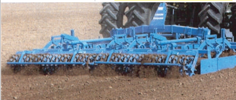
Figure 3: Combinaison d'outils portés ou semi-portés à l'arrière du tracteur
