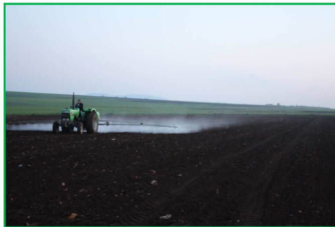
Figure 10 : Incidence de dérive due à une pression et vitesse de travail élevées (photo El Aissaoui A.)
