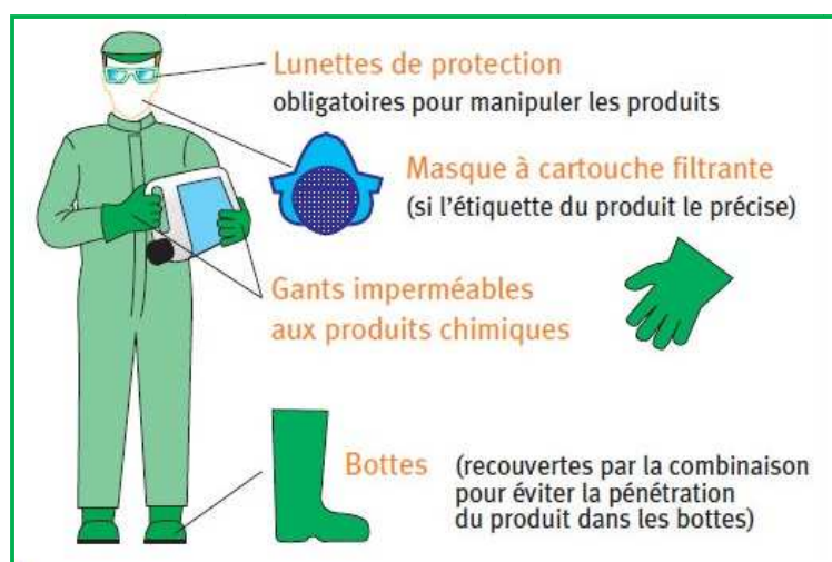
Figure 20 : La manipulation des produits chimiques nécessite le port des équipements de protection personnelle
