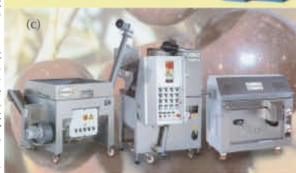
Unités modernes de trituration d'olives équipées en chaînes continues (a et b) de trois phases (grignon, margine, huile) ou (c) de deux phases (grignon humidifié, huile)
