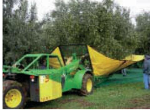
Figure 37. Véhicule automatisé avec parapluie renversé.
