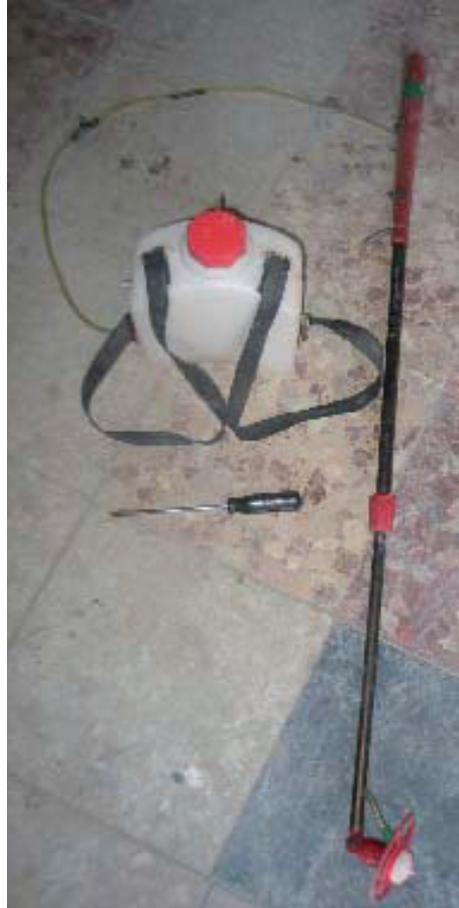
Figure 3. Pulvérisateurs avec buse centrifuge fonctionnant avec piles électriques.
