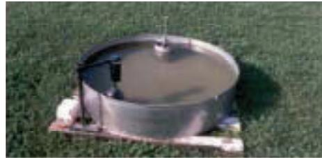
Figure 1. Cuve évaporimétrique de classe 'A' avec senseur pour l'enregistrement automatique des données.
