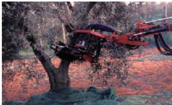
Figure 36. Fixation d'un vibreur sur une branche.
