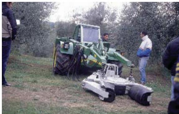
Figure 22. Vibreur avec deux masses excentriques et un moteur hydraulique.
