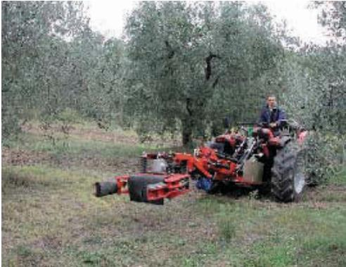
Figure 23. Vibreur avec une seule masse excentrique.
