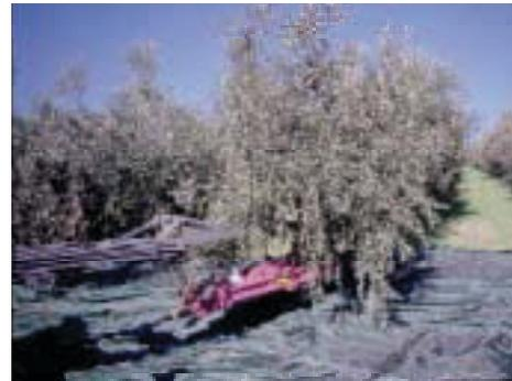
Figure 30. Vibreur de tronc et filets.
