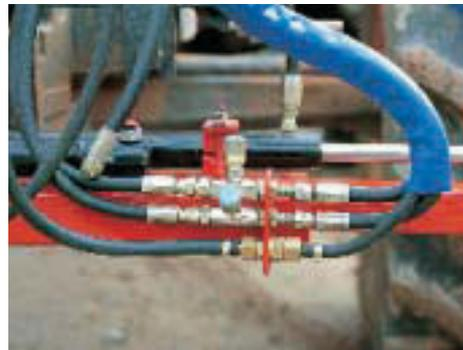
Figure 5. Détails du distributeur, du filtre et des tubes et mécanismes hydrauliques d'extension de la rampe.
