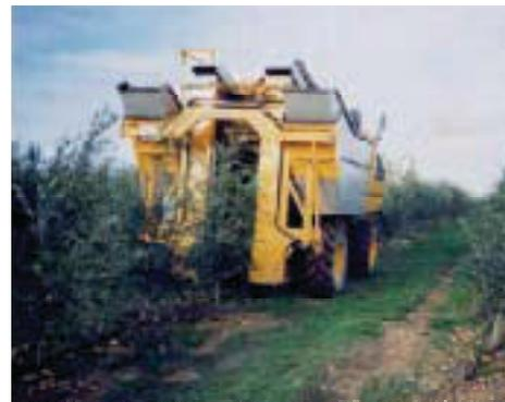
Figure 25. Récolteuse avec espace de vibration augmenté.
