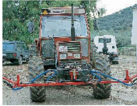
Figure 4. Pulvérisateur de traction mécanique muni d'un réservoir de grande capacité et de rampes portes-buses à l'avant et à l'arrière.
