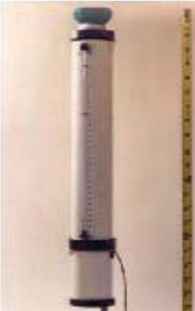
Figure 2. Atmomètre (d'après Altenhofen, 1985).
