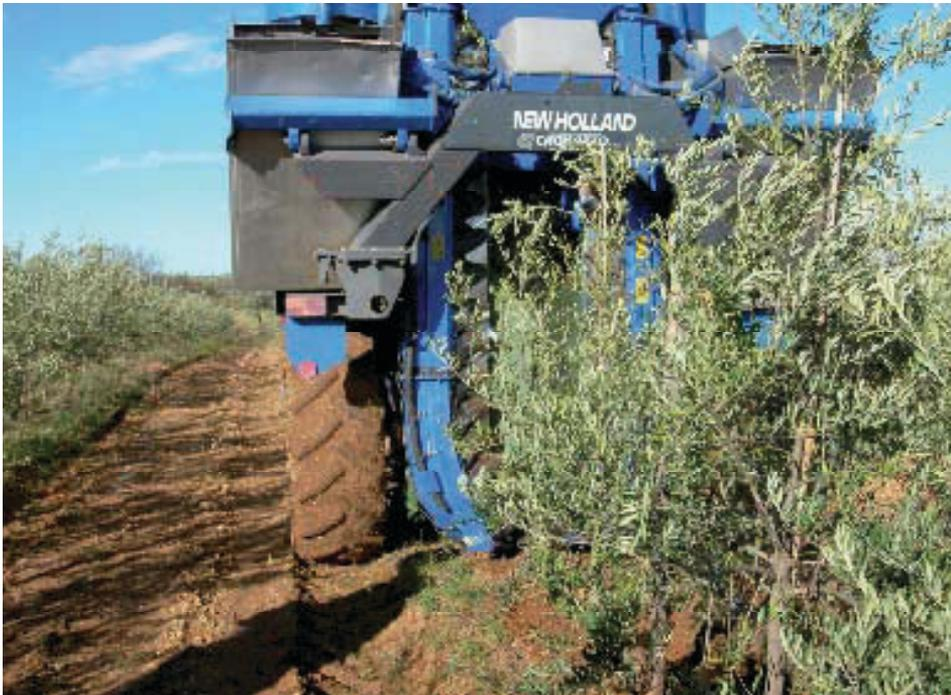
Figure 31. Récolte avec un équipement de type vendangeuse dans une plantation superintensive.
