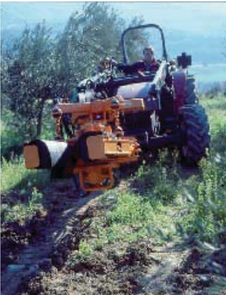
Figure 21. Vibreurs à deux masses et deux moteurs indépendants.
