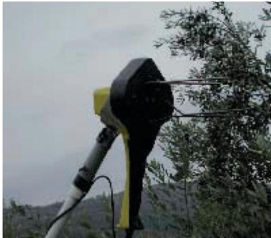
Figure 13. Fourche avec doigts courbés.
