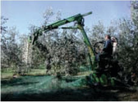
Figure 19. Secoueur à doigts radiaux.
