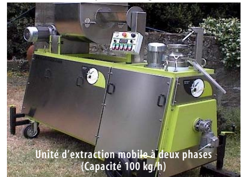
Unité d'extraction mobile à deux phases (Capacité 250 kg/h)
