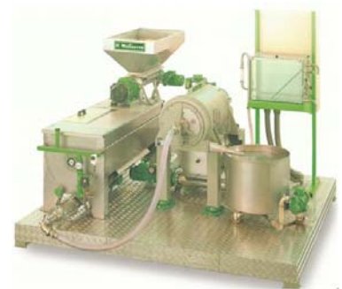
Unité d'extraction mobile à deux phases (Capacité 250 kg/h)
